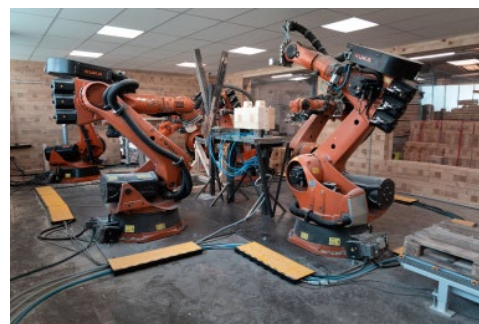
Produktion der Massivholz-Bausteine im Stammwerk von TRIQBRIQ. Foto: David Jäger / TRIQBRIQ
